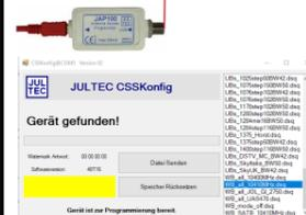
Mit dem Programmierer JAP 100 und dem File WB\_all\_10410MHz müssen beide TN-Ausgänge auf Breitband-Modus umprogrammiert werden.
