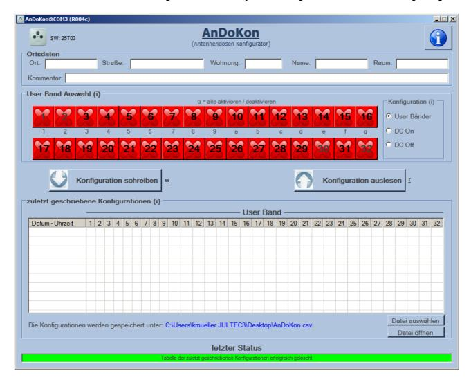
Im Beispiel hat die Antennensteckdose die Softwarerevision 25T03, mit dieser können 32 Userbänder konfiguriert werden. Ebenso kann der DC-Pfad gezielt Ein- oder ausgeschaltet werden.
